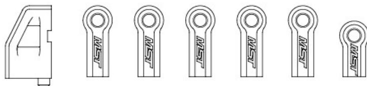
4.8 Rod ends set (M/S) ×2 4.8 拉桿頭組 (M/S) 230067
